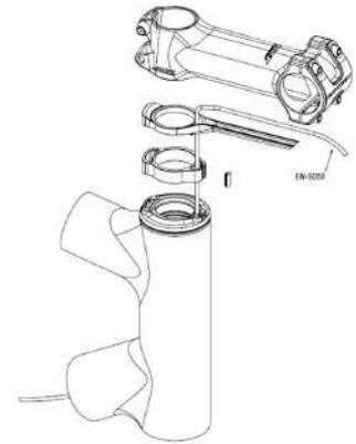
El juego de dirección más nuevo de Ritchey diseñado para facilitar el guiado interno de los cables, en 2 versiones; Universal compatible con cualquier potencia y Switch compatible con la potencia Ritchey Switch.
